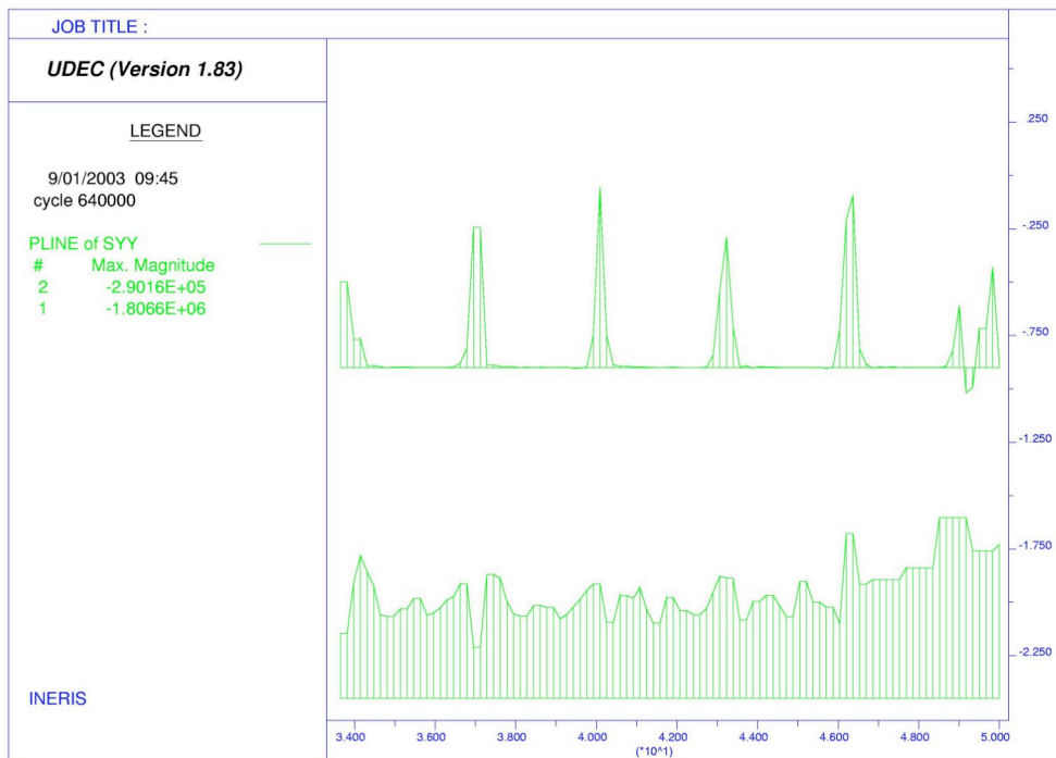
Figure 17 : Modèle n°3, \sigma_{yy} à la surface et à la base de la fondation pour la moitié droite du stylobate
